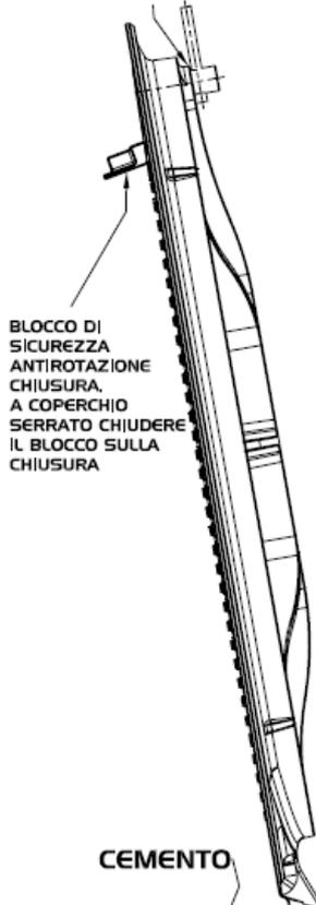
BLOCCO DI SICUREZZA ANTIROTAZIONE CHIUSURA. A COPERCHIO SERRATO CHIUDERE IL BLOCCO SULLA CHIUSURA
